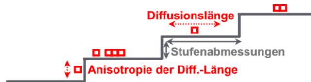
Abbildung 12 Unregelmäßigkeiten auf Oberflächen und die Diffusion zusätzlicher, aus der Gasphase ankommender Atome auf dieser Oberfläche. Bild: Elke Stangl
