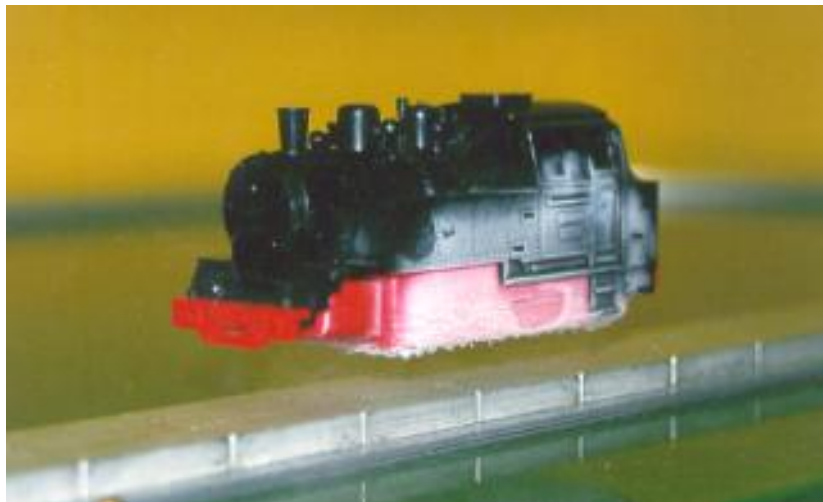
Abbildung 8 Modellversuch – schwebende Spielzeugeisenbahn – zur Demonstration der Verdrängung des magnetischen Feldes aus einem (Hochtemperatur-)Supraleiter. Mit freundlicher Genehmigung von Ludwig Schultz, IWF Dresden [Krome 2002].
